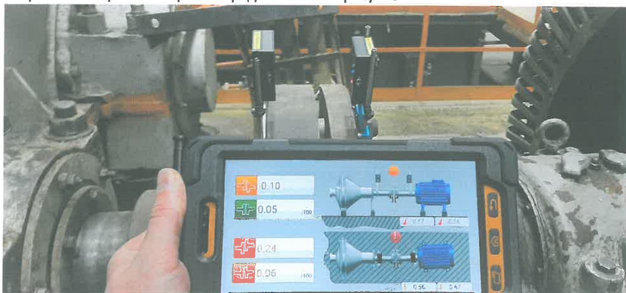
Рис. 4 – Результаты второго измерения взаимного расположения осей вращения валов привода сырьевой мельницы
