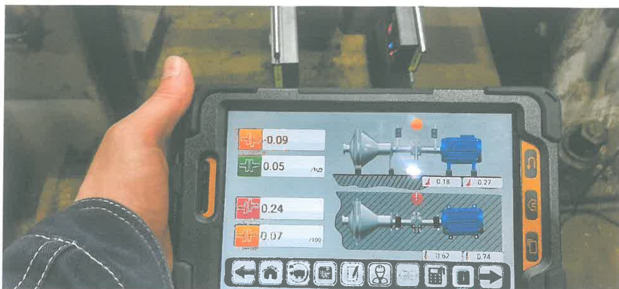
Рис. 3 – Результаты первого измерения взаимного расположения осей вращения валов привода сырьевой мельницы
