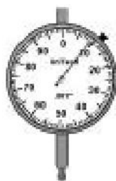
Рис.5.53 Установите на индикаторах положительные значения
