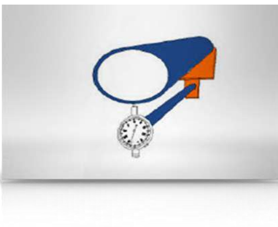
Рис.5.5 Определение прогиба, измерение в положении 6:00.
