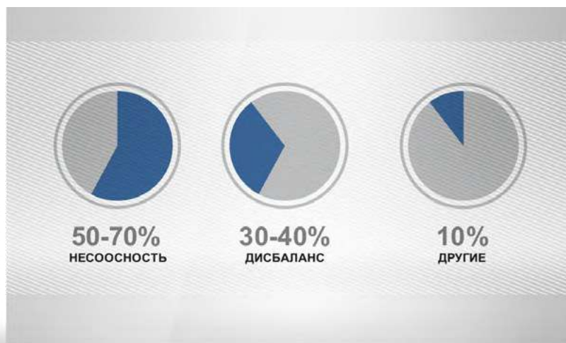
Рис 4.3 Основные источники вибрации машинного оборудования
