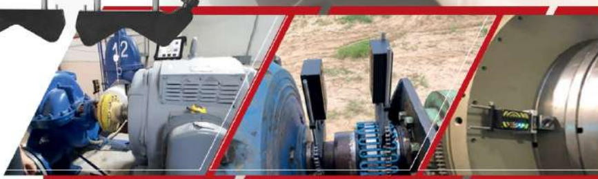
Рис.3.8 Лазерная система VIBRO-LASER использует 2 лазера и 2 приемника
