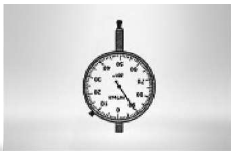
Рис.5.22 Установка значения прогиба
