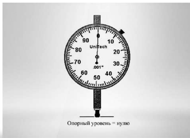
Рис.5.2 Показания часового индикатора
