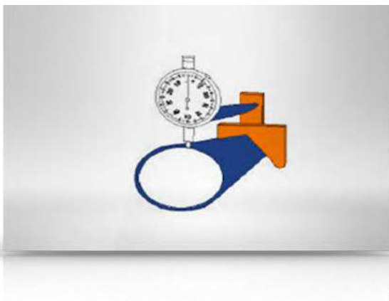
Рис.5.4 Определение прогиба, ноль в положении 12:00.
