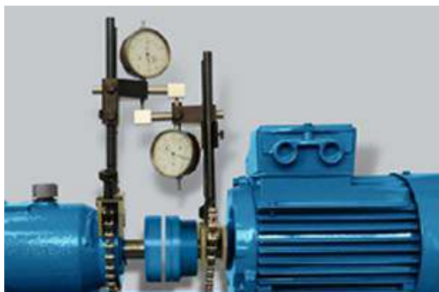
Рис.5.45 Крепления метод обратных индикаторов
