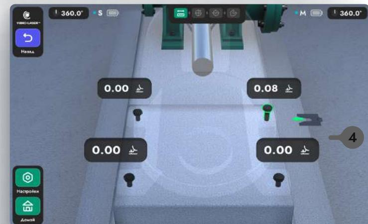
**4** Под указанную лапу опоры необходимо подложить пластину. В ячейке указано значение в «мм», на которое нужно скорректировать опору.
